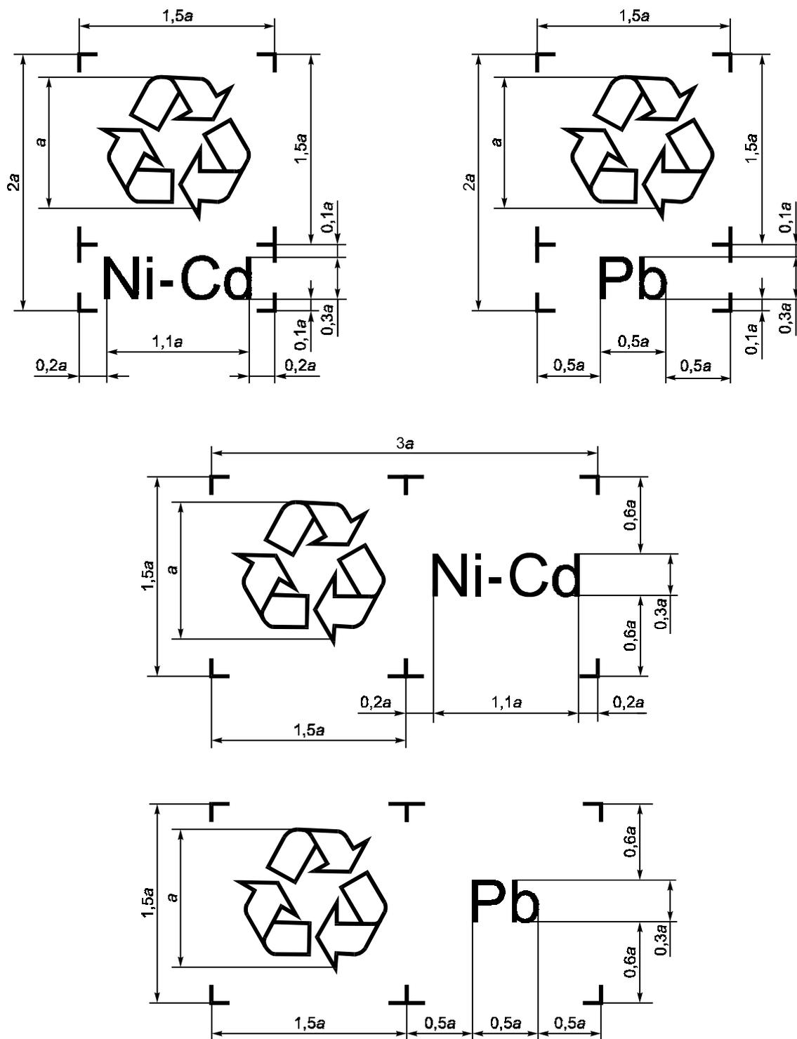
Рисунок 2 — Местоположение символов переработки и электрохимической системы батареи
